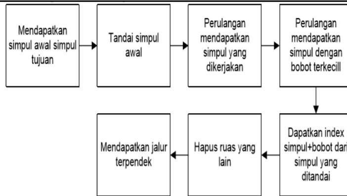
Gambar 7. Flow Algoritma Dijkstra
